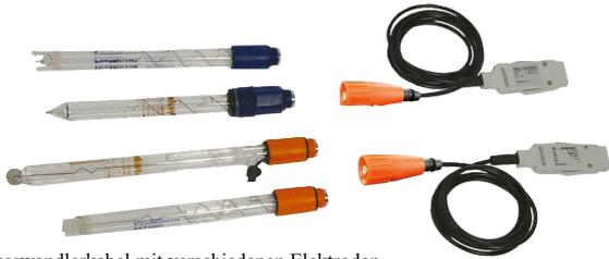
Messwandlerkabel mit verschiedenen Elektroden
