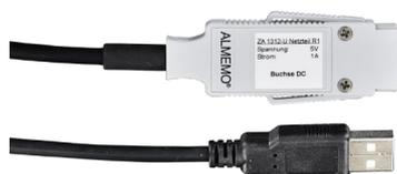
ALMEMO® Versorgungskabel mit USB-Stecker. NICHT galv. getr., 5 V DC über USB-Powerbank oder PC. USB-Stecker mit 1,5 m Kabel und ALMEMO® Versorgungsstecker ZA 1312-FS8. Für ALMEMO® Geräte (ab Baujahr 2014) 2490, 2470, 2590-2A/4AS, 2690, 202-S, 204 **ZA1312U**
