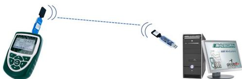
**Drahtlose PC-Verbindung über Funk**
