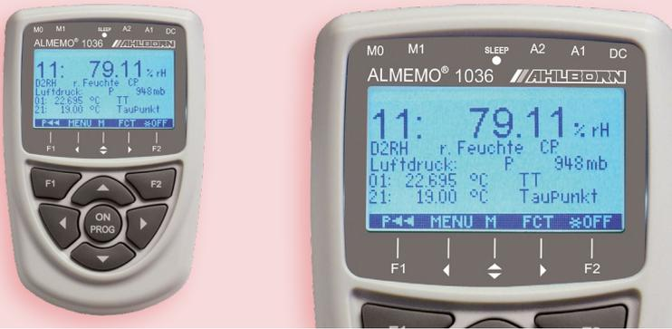
**ALMEMO® Referenzmessgerät für Feuchte und Temperatur. Hochpräzise Messung mit Pt100-Psychrometer und Pt100-Fühlern. Auflösung Temperatur 0,001 K, Relative Feuchte 0,01 %, Taupunkt 0,01 K**
