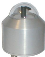
Globalstrahlungs-Messkopf FLA613GS-SDEK, Messung der globalen, direkten und diffusen Sonnenstrahlung (eingebauter Schattenbügel), spektrale Empfindlichkeit 380 nm bis 1100 nm.
