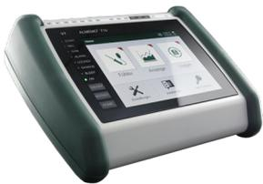
10 Eingänge für beliebige ALMEMO® Fühler, im Messgerät eingebaute Luftdrucksensor
